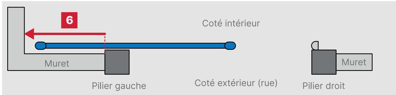
Prenez la mesure, en mm, du **bord du pilier** jusqu'au premier obstacle du côté de votre ouverture.
